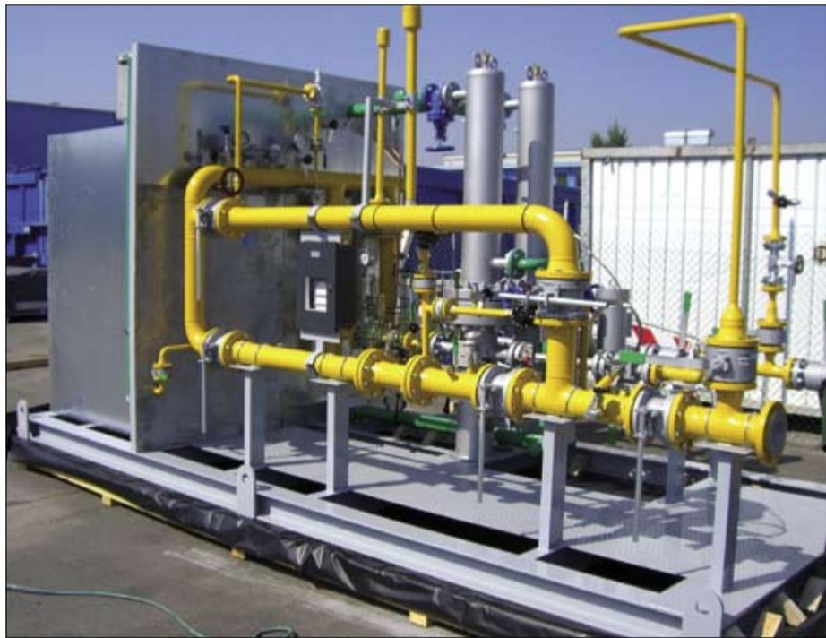
■ Stazione completa di filtrazione, preriscaldamento, riduzione, misura del gas metano
